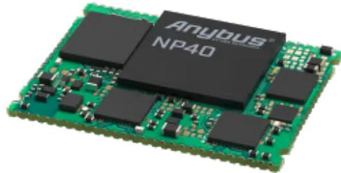
*Ermöglicht Automatisierungsgeräten die Kommunikation mit PROFINET-Netzwerken*
