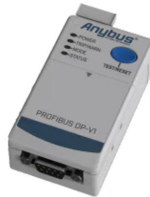
*PROFIBUS DVP1 Slave-Funktionsmodul für elektronisches Überlastrelais Allen-Bradley E300*
