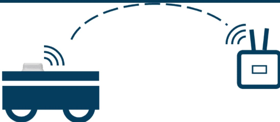
Der Anybus Wireless Bolt II kann an Roaming-Maschinen wie FTS angebracht werden, sodass die Maschine mit verschiedenen Zugangspunkten in der gesamten Anlage verbunden werden kann. Er tauscht Informationen über den besten Weg aus, damit die Maschine effizient und sicher ans Ziel kommt.
