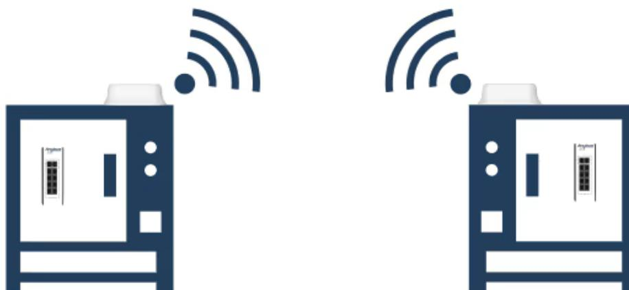
Der Anybus Wireless Bolt II wird als Access Point konfiguriert und an einem Schaltschrank montiert, um einen drahtlosen Zugriff zwischen einem HMI und den Geräten im Schaltschrank zu ermöglichen. Der Bolt II wird über einen PoE-Switch im Inneren des Schrankes mit Strom ausgestattet.
