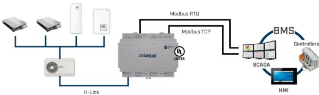
Beispiel für die Integration: Wenn das Gateway zur Integration von gemischten Gerätetypen wie VRF- und Air-to-Water-Systemen verwendet wird.
