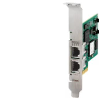
将计算机和嵌入式系统连接到EtherNet/IP网络
