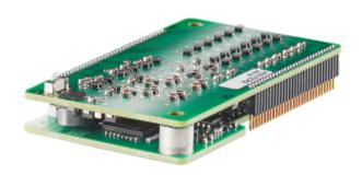
Ermöglicht den Anschluss von Geräten an sichere Feldbusse über PROFIsafe
