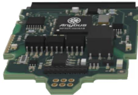
*Ermöglicht Automatisierungsgeräten die Kommunikation mit EtherNet/IP-Netzwerken*
