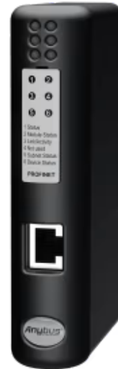
Protokollkonverter zur Anbindung von CANopen-Geräten an PROFINET-IO-SPSen
