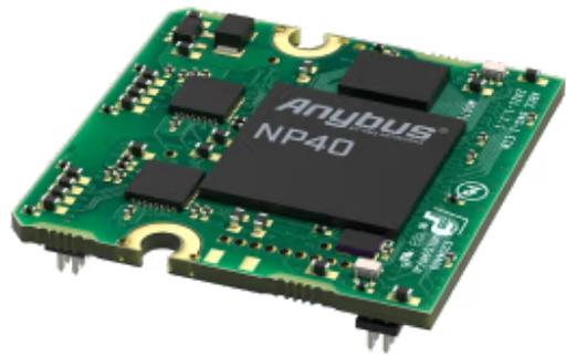
*Ermöglicht Automatisierungsgeräten die Kommunikation mit PROFINET-IRT-Netzwerken*
