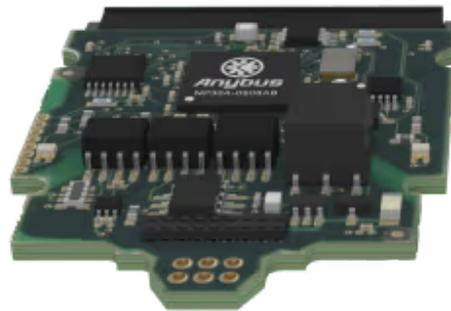
*Kommunikation zwischen Industriegeräten und DeviceNet-Netzwerken ermöglichen*
