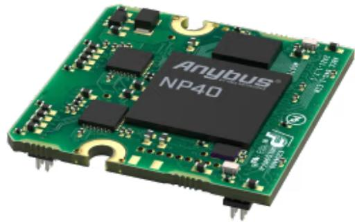
*Ermöglicht Automatisierungsgeräten die Kommunikation mit EtherNet/IP-Netzwerken*
