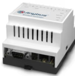
Mit dem Anybus Modbus RTU-auf-TCP-Gateway können Sie Modbus-TCP-Geräte mit Modbus RTU-Steuerungssystemen verbinden. Das Gateway fungiert als Übersetzer (Router) zwischen den beiden Netzwerken und ermöglicht den Anschluss von bis zu 32 Modbus-RTU-Geräten an ein Modbus-TCP-Netzwerk.
