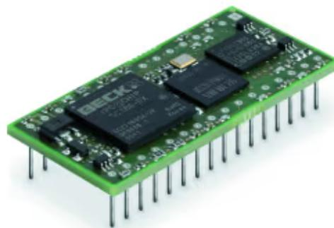
*Embedded SoC-Web-Controller mit DIL32-Footprint für Smart Grid-Anwendungen.*
