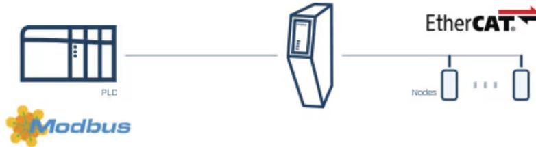
Der Communicator kann überall dort eingesetzt werden, wo Daten zwischen Steuerungssystemen mit unterschiedlichen Industrieprotokollen übertragen werden müssen.
