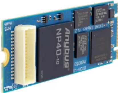
将计算机和嵌入式系统连接到PROFINET IRT网络
