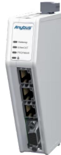
*Protokollkonverter zur Verbindung von EtherCAT- und PROFIBUS-DP-Steuerungen*
