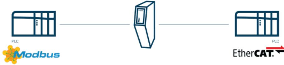
Der Communicator kann überall dort eingesetzt werden, wo Daten zwischen Steuerungssystemen mit unterschiedlichen Industrieprotokollen übertragen werden müssen.
