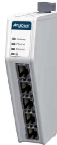
*Ein Protokollkonverter, der Modbus-TCP-Geräte mit Industrial-Ethernet-Steuerungssystemen verbindet*
