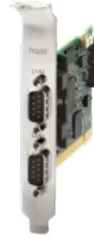
用于CAN (2 x CAN) 的PC接口卡，电气隔离
