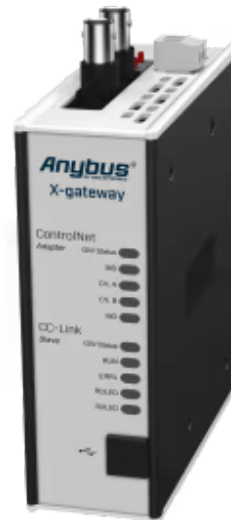
Protokollkonverter zur Verbindung von CC-Link- und ControlNet-Steuerungssystemen
