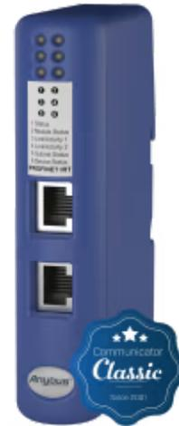
*Ein Protokollkonverter, der serielle Geräte mit PROFINET-IRT-Steuerungen verbindet.*
