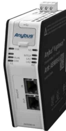
*Ein Protokollkonverter, der Modbus-TCP-Geräte mit EtherCAT-SPSen verbindet*
