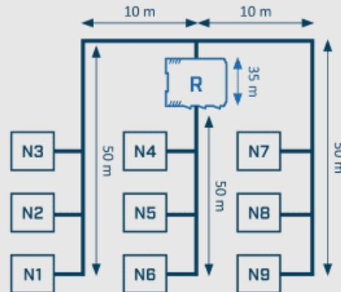
CAN 中继器可用于更好地使电缆布线适应环境条件。可以制作短线，总线结构可以扩展为星形/树形结构，从而节省电缆长度。较短的电缆长度减少了对信号线的干扰，并实现了更高的比特率。通过中继器连接的网段是电气解耦的，因此为连接的参与者提供过压保护。
