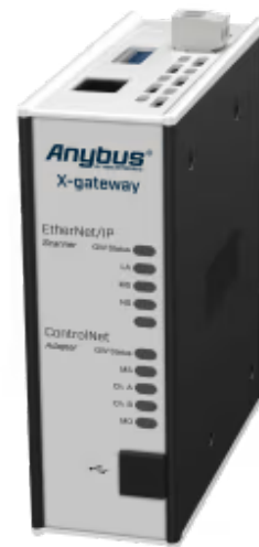
Ein Protokollkonverter, der EtherNet/IP-Geräte mit ControlNet-SPSs verbindet
