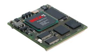
Ein "Computer on Module" basierend auf der hochintegrierten 32-Bit Power Architecture™ Technologie. Entwickelt für anspruchsvolle Steuerungsaufgaben und intensive Netzwerkkommunikation.
