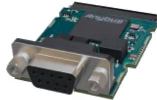
*Ermöglicht transparente RS-232-Kommunikation*
