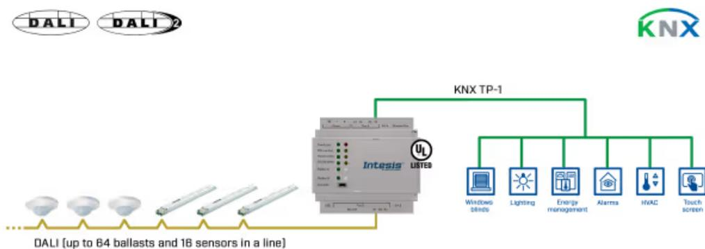
将 DALI 驱动程序和传感器集成到 KNX 装置中。
