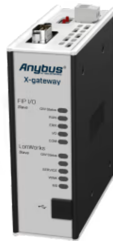
Ein Protokollkonverter, der FIPIO- und Lonworks-Steuerungssysteme verbindet
