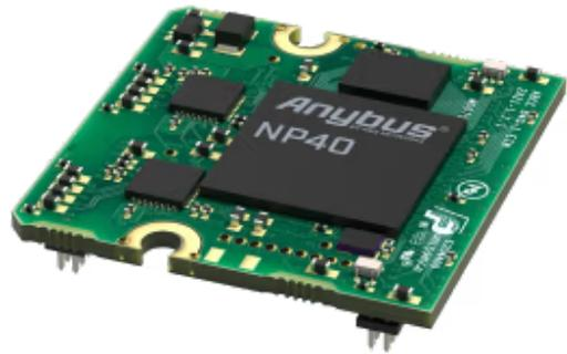
*Ermöglicht Automatisierungsgeräten die Kommunikation mit Industrial-Ethernet-Netzwerken*
