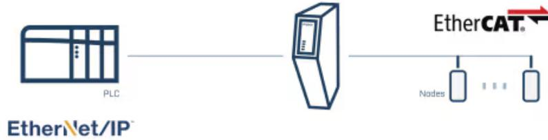
Der Communicator kann überall dort eingesetzt werden, wo Daten zwischen Steuerungssystemen mit unterschiedlichen Industrieprotokollen übertragen werden müssen.
