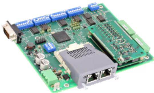
*Ermöglicht die Verbindung von Geräten mit sicheren Feldbussen durch Functional Safety ETC*
