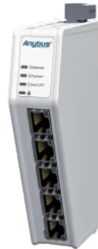
*Protokollkonverter zur Anbindung von EtherCAT-Geräten an Industrial-Ethernet-Netzwerke*
