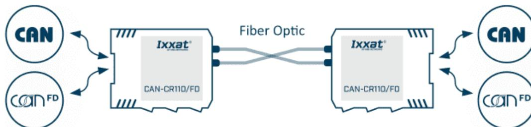
LWL-CAN-FD-Repeater ermöglichen die Überbrückung störungsintensiver Strecken mittels Lichtwellenleitern. Sie ermöglichen eine vollständige galvanische Entkopplung der Segmente und bieten einen hohen Überspannungsschutz.
