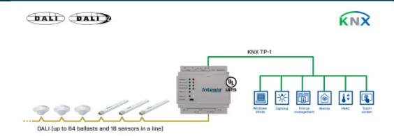
$\label{thm:condition} \textbf{Integration von DALI-Treibern und -Sensoren in eine KNX-Installation}.$
