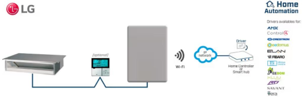
Integration von LG Commercial Line und VRF-Klimageräten in eine Hausautomationsanlage.
