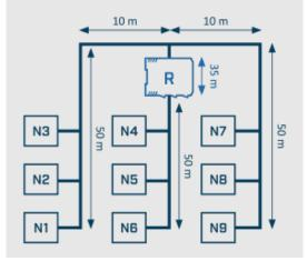
Mit CAN-Repeatern kann die Kabelführung besser an die Umgebungsbedingungen angepasst werden. Es können Stichleitungen hergestellt und die Busstruktur zu einer Stern/Baum-Struktur erweitert werden, was Kabellängen spart. Kürzere Leitungslängen reduzieren Störungen auf den Signalleitungen und ermöglichen höhere Bitraten. Über Repeater verbundene Segmente sind galvanisch entkoppelt und bieten somit einen Überspannungsschutz für angeschlossene Teilnehmer.
