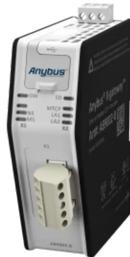
Ein Protokollkonverter, der Modbus-TCP-Geräte mit DeviceNet-SPSen verbindet
