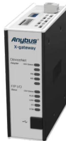
Ein Protokollkonverter zur Verbindung von DeviceNet- und FIPIO-Steuerungssystemen
