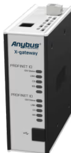
Protokollkonverter zur Verbindung von PROFINET-IO-Steuerungen
