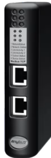
Ein Protokollkonverter, der CANopen-Geräte mit Modbus-TCP-SPSen verbindet
