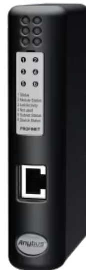
Protokollkonverter zur Anbindung von CANopen-Geräten an PROFINET-IO-SPSen
