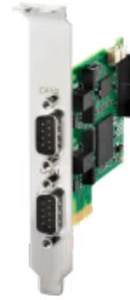
用于CAN (2 x CAN) 的PC接口卡, 电气隔离
