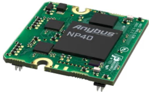
*Ermöglicht Automatisierungsgeräten die Kommunikation mit PROFIBUS-Netzwerken*
