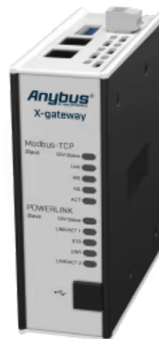
Ein Protokollkonverter zur Verbindung von Modbus TCP- und POWERLINK-Steuerungssystemen
