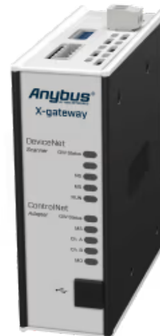
Ein Protokollkonverter, der DeviceNet-Geräte mit ControlNet-Steuerungen verbindet
