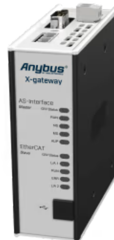
Protokollkonverter zur Anbindung von AS-Interface-Geräten an EtherCAT-SPSen
