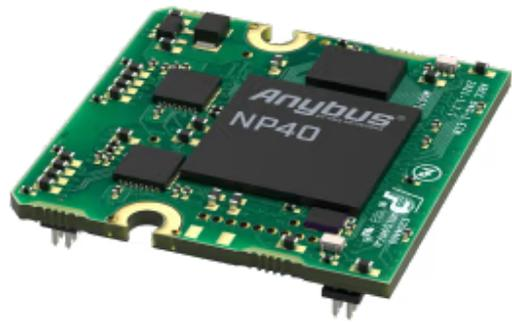
*Ermöglicht Automatisierungsgeräten die Kommunikation mit POWERLINK-Netzwerken*
