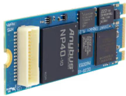
将计算机和嵌入式系统连接到工业以太网
