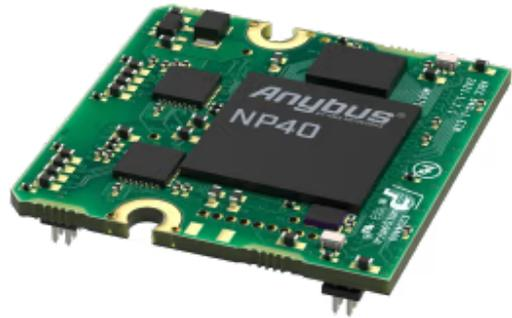
*Ermöglicht Automatisierungsgeräten die Kommunikation mit Industrial-Ethernet-Netzwerken*
