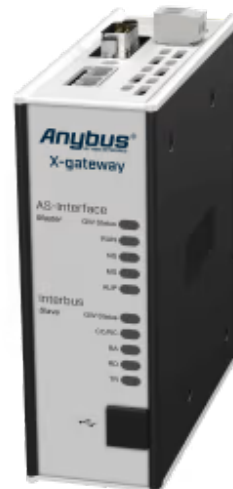
Ein Protokollkonverter, der AS-Interface-Geräte mit Interbus-CU-SPSen verbindet
